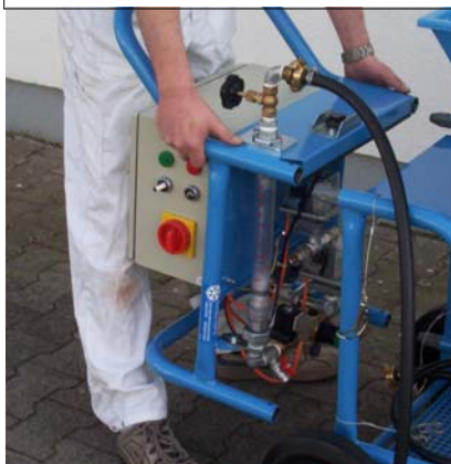
Haut: stator facilement démontable Gauche: Coffret électrique démontable pour le transport ou autre
