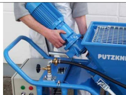
Le moteur est basculé sur le côté pour le nettoyage de la trémie et du tube de malaxage
